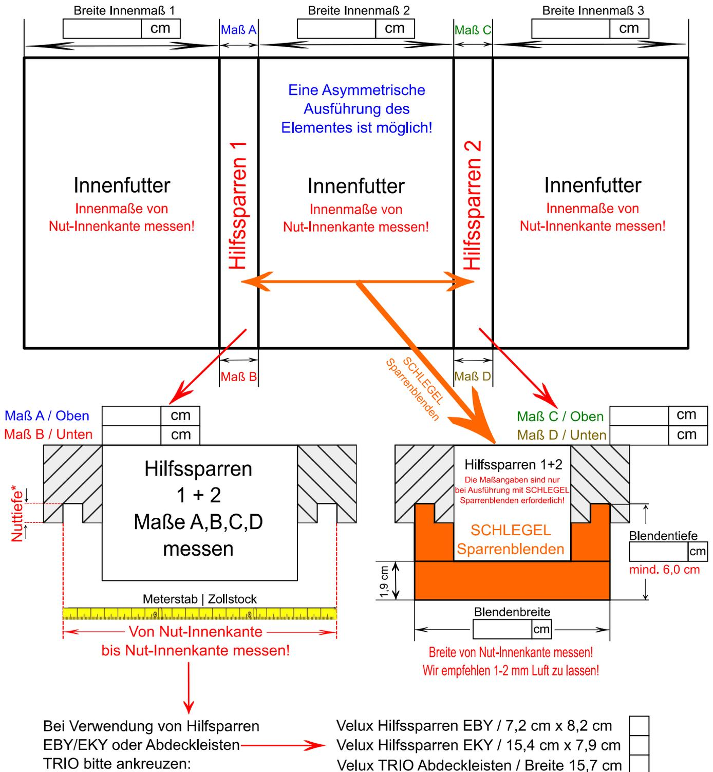
**Achtung, unsere Innenfutter haben Materialstärke 19 mm, Dämmung und Dampfsperre mit ausreichend Abstand für das Innenfutter herstellen!**
