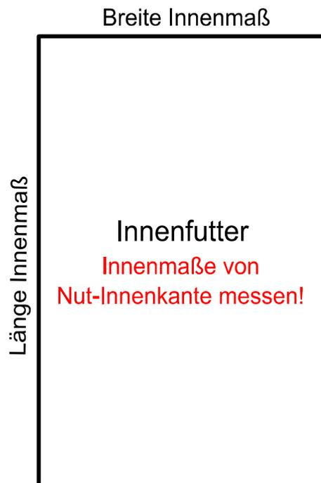
Achtung, unsere Innenfutter haben Materialstärke 19 mm, Dämmung und Dampfsperre mit ausreichend Abstand für das Innenfutter herstellen!
