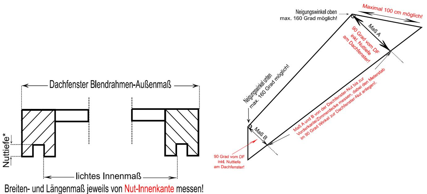
\*Nuttiefe: Zum Ausgleich von Unebenheiten an der Decke ca. 4 mm Luft in der Dachfensternut von der Futtertiefe abziehen!
