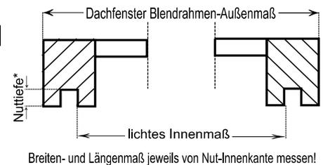
\*Nuttiefe: Zum Ausgleich von Unebenheiten an der Decke ca. 4 mm Luft in der Dachfensternut von der Futtertiefe abziehen!
