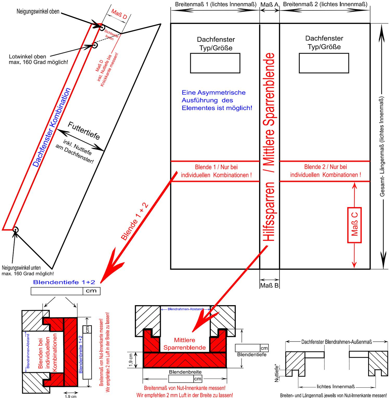
\*Nuttiefe: Zum Ausgleich von Unebenheiten an der Decke ca. 4 mm Luft in der Dachfensternut von der Futtertiefe abziehen!
