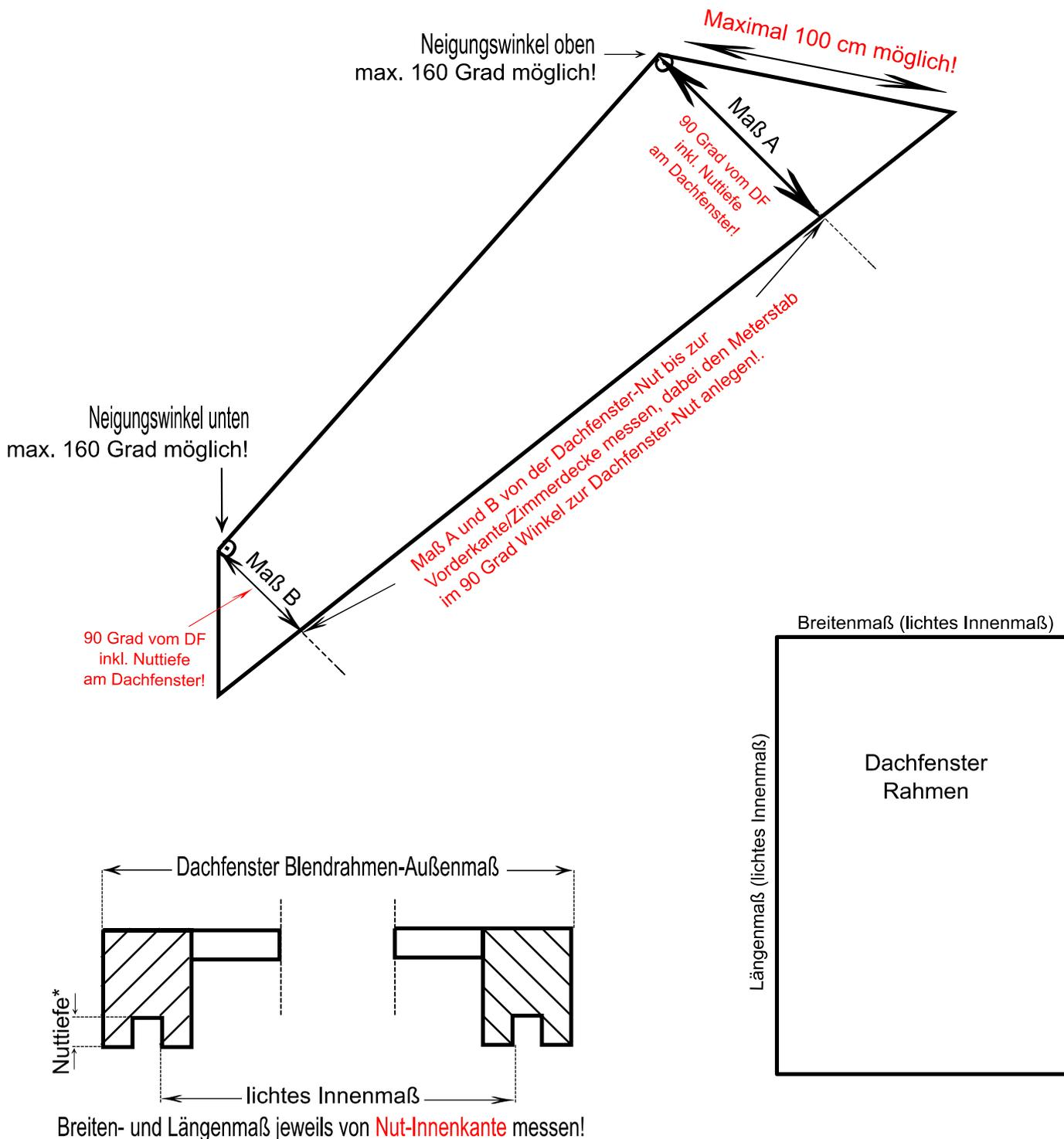
\*Nuttiefe: Zum Ausgleich von Unebenheiten an der Decke ca. 4 mm Luft in der Dachfensternut von der Futtertiefe abziehen!
