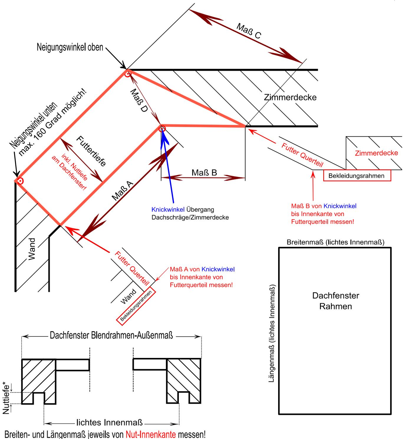
\*Nuttiefe: Zum Ausgleich von Unebenheiten an der Decke ca. 4 mm Luft in der Dachfensternut von der Futtertiefe abziehen!
