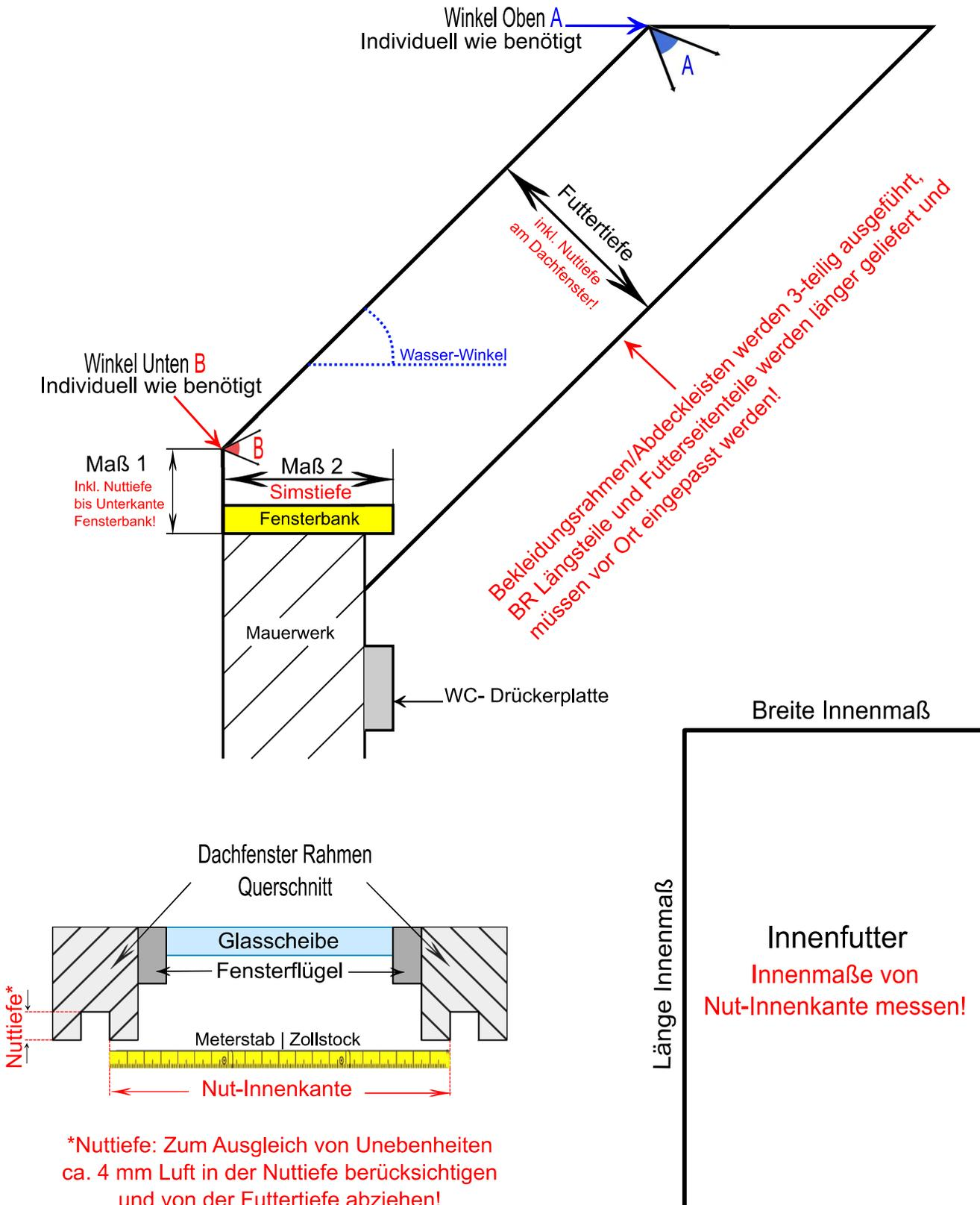
**Achtung, unsere Innenfutter haben Materialstärke 19 mm, Dämmung und Dampfsperre mit ausreichend Abstand für das Innenfutter herstellen!**
